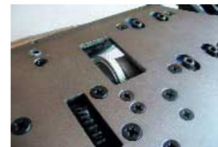
**Durch die großzügige Aussparung im Chassis lässt sich der Motor auch mittels Startbox starten. Alle Schrauben sind im Chassis versenkt. So kann im Gelände nichts passieren**
