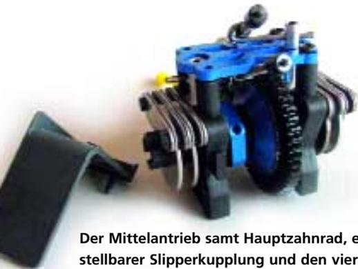
**Der Mittelantrieb samt Hauptzahnrad, einstellbarer Slipperkupplung und den vier (!) Bremscheiben. Der Schutz gegen übergefahrenen Sprit liegt gleich daneben und wird über der vorderen Bremse montiert**
