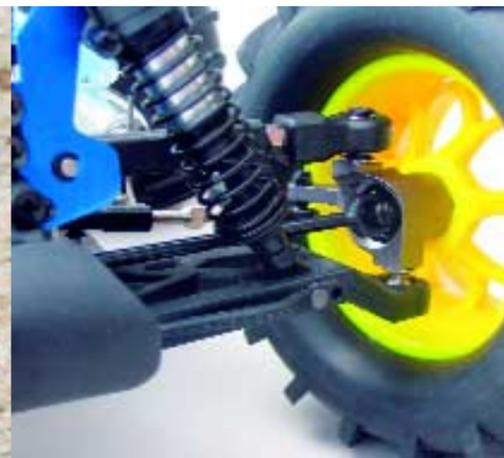
**Gefräste Lenkhebel, Kardanwellen an der Vorderachse und Aluminiumdämpfer lassen den Rancho zum Pro werden. Gut zu erkennen ist auch der „Knick“ im unteren Querlenker, um die Beinfreiheit zu erhöhen**
