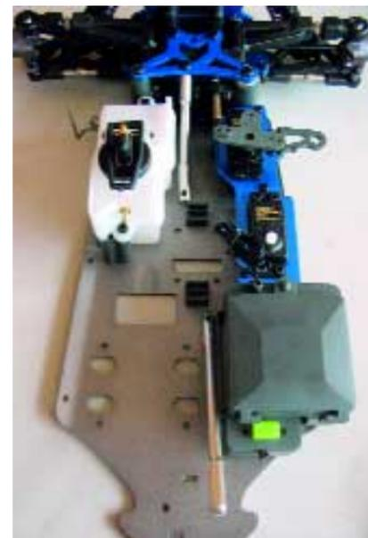
Auch hier findet man Ähnlichkeiten zum Buggy. Ist der Motor demontiert, kann man sehen, dass auch andere Triebwerke installiert werden können. Die große Radiobox kann locker einen fünfzelligen Empfängerakkupack und den Empfänger samt Failsafe-Einheit aufnehmen
